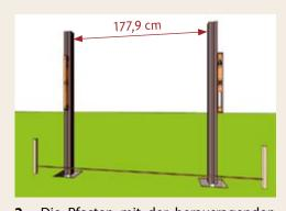
**2** - Die Pfosten mit der herausragenden Stahlverstärkung nach unten in die Fundamentlöcher setzen und mit einer Wasserwaage ausrichten (von zwei Seiten, 90° versetzt). Die Pfosten so einrichten, dass der lichte Abstand zwischen den Innenseiten der Pfosten ca. 177,9 cm beträgt.
