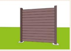
**12** - Die Füllungsprofile werden anschließend bis auf eine maximale Höhe von 180 cm aufeinandergesteckt.
