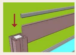
**18** - Abschließend das oberste Füllungsprofil sowie das Aluminium-Abschlussprofil aufstecken.
