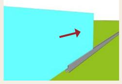
15 - Optional kann ein Designelement (Glasoder Lochblecheinsatz) in zwei verschiedenen Größen (15 und 30 cm) eingefügt werden. Dieses wird anstelle von einem bzw. zwei Füllungsprofilen eingebracht. Hierzu das Designelement zuerst in die Nut der unteren Aluminium-Adapterleiste zwischen die Bürstendichtungen von der Seite einschieben.
