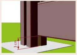
**10** - Das unterste Füllungsprofil steht auf den Distanzstücken auf und erhält somit eine Bodenfreiheit von ca. 3 cm. Sollte weniger Bodenfreiheit gewünscht sein, ist das Distanzstück zu kürzen.
