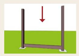
**9** - Das erste Füllungsprofil wird von oben mittig zwischen den beiden Pfostennuten positioniert und bis auf die Distanzstücke heruntergedrückt.
