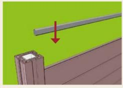
**13** - Als obere Profilabdeckung wird ein Abschlussprofil aus Aluminium aufgesteckt.
