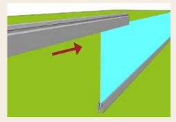
**16** - Anschließend wird die obere Aluminium-Adapterleiste mit den Bürstendichtungen oben auf das Designelement von der Seite aufgeschoben.
