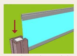
17 - Nun das Designelement mit den beiden Adapterleisten aus Aluminium zusammen vorsichtig zwischen die Pfostennuten einschieben und auf das untere Füllungsprofil aufschieben und einklicken.
