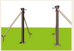
**3**- Die Pfosten mit Holzleisten und Schraubzwingen zum nachfolgenden Einbetonieren abstützen. Zwischen Schraubzwinge und Pfostenoberfläche kleine Hölzer legen, um Kratzer zu vermeiden! Nochmalige Kontrolle des korrekten Pfostenabstands und der senkrechten Ausrichtung!
