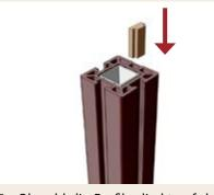
**7** - Obwohl die Profile direkt auf dem Untergrund verlegt werden können, empfehlen wir, ein jeweils ca. 3 cm langes Stück Nutleiste von oben in die Aufnahmenuten einzuschieben. Diese dienen als Distanzstücke unter dem unteren Füllungprofil. In diesem Fall ist das untere Profilbrett mittig zu unterfüttern, so dass dieses nicht durchbiegt.
