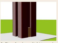
**8** - Die ca. 3 cm langen Nutleisten werden bis auf den festen Untergrund heruntergeschoben und gegebenenfalls verschraubt.
