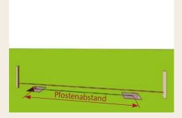
1 - Nach der Planung des Zaunverlaufs diesen mittels einer Richtschnur und Holzpfosten festlegen. Hierbei unbedingt den Höhenverlauf des Geländes berücksichtigen. Das Ausheben der Pfostenlöcher erfolgt mit einem Spaten. Die Löcher ca. 30 x 30 cm groß und je nach Bodenbeschaffenheit mindestens 50 cm tief anlegen.
