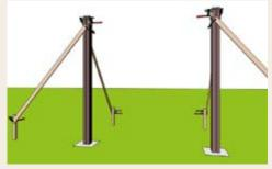
4 - Fertig- oder Estrichbeton in erdfeuchtem Zustand in die Erdlöcher füllen. Den Beton mit einem Kantholz verdichten! Zwischendurch immer wieder den korrekten Stand der Pfosten kontrollieren! Abschließend verbliebende Betonreste mit etwas Wasser von den Pfosten entfernen! Den Beton laut Packungsangabe (mind. 24 Std.) abbinden lassen. Die Pfosten bis zum Abbinden des Betons abstützen.
