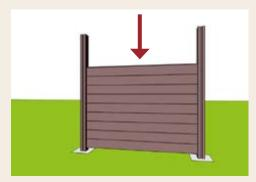
11 - Die weiteren Füllungsprofile werden nacheinander von oben eingeschoben. Die Nuten der Füllungsprofile sind hierbei nach unten gerichtet und greifen in die Feder des vorigen Profils ein. Ein 180 cm hohes Zaunelement besteht aus 12 übereinander gesteckten Füllungsprofilen. Optional besteht die Möglichkeit, ein bzw. zwei Füllungsprofile durch ein Designelement (Glas oder Lochblech) zu ersetzen (siehe hierzu ab Bild 15 folgend).
