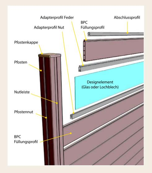
Unsere BPC-Profile bestehen aus Bambus-Polymer-Composite, einem Werkstoff aus Bambusfasern und HDPE (High Density PolyEthylen). Sie sind durchgefärbt und benötigen keinen zusätzlichen Anstrich.
