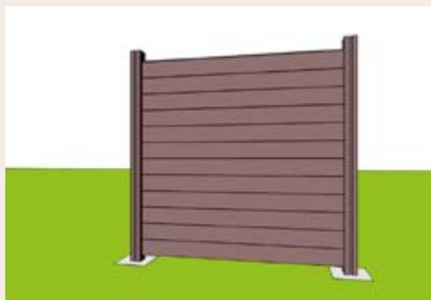
**12.** Les lamelles sont ensuite superposées jusqu'à une hauteur maximale de 180 cm.
