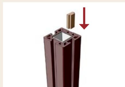
**7.** Quand les deux poteaux sont montés, faites glisser la baguette rainurée d'env. 5 cm de long depuis le haut vers le bas dans la rainure afin d'éviter le contact direct de la lamelle inférieure avec le sol. Celles-ci servent d'entretoises au-dessous de la lamelle inférieure.
