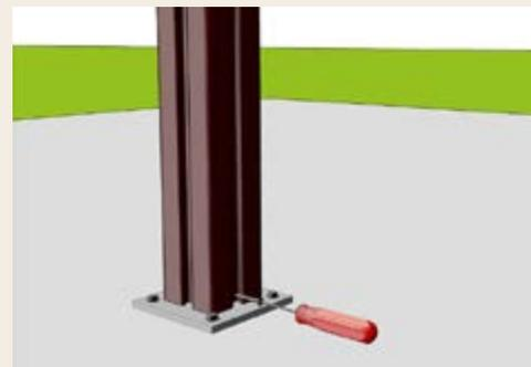
**6.** Placez ensuite les poteaux sur les consoles et fixez avec deux vis en métal opposées à visser en diagonale sur le bord inférieur du poteau.
