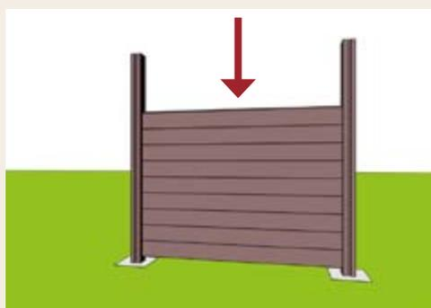
**11.** Les lamelles sont insérées depuis le haut les unes après les autres. Les rainures sont orientées vers le bas et s'emboîtent avec la lamelle d'avant. Un panneau de clôture de 180 cm de haut se compose de 12 lamelles superposées.
