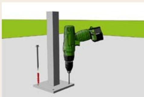
**5.** Sinon, en cas de fondations en béton ou de présence d'une construction en socle, des consoles à visser peuvent être utilisées. En fonction de leur taille, celles-ci sont orientées comme lors du bétonnage et fixées avec une combinaison adaptée de vis et de chevilles.
