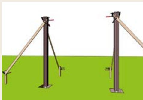
**3.** Caler les poteaux avec des baguettes en bois et des serre-joints pour le bétonnage ultérieur. Placer de petites cales en bois entre le serre-joint et la surface du poteau pour éviter les rayures !
