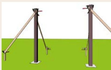
**4.** Remplir les trous dans le sol humide de béton prêt à l'emploi ou de béton pour chape. Comprimer le béton avec une cale en bois ! Pendant toute la procédure, vérifier que les poteaux restent bien positionnés ! Pour finir, éliminer à l'eau les résidus de béton sur les poteaux ! Laisser le béton durcir selon les indications sur l'emballage (au moins 24 heures). Caler les poteaux jusqu'au durcissement du béton.
